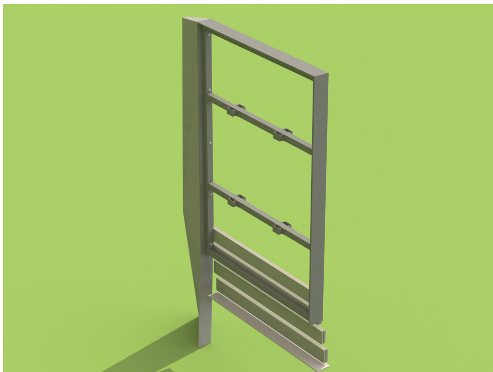
Obr. 12: Konstrukce rámu s odjímatelnou spodní deskou
