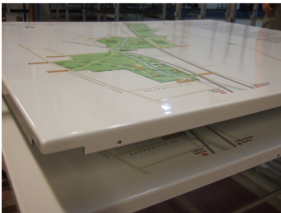
Obr. 21: Rovné smaltované panely s pravoúhle zahnutými okraji
