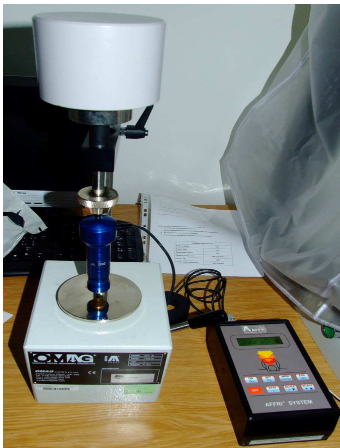
Obr. 33. Zkušební zařízení pro měření zkoušky tvrdosti dle Shoreho OMAG AFRR RT 13
