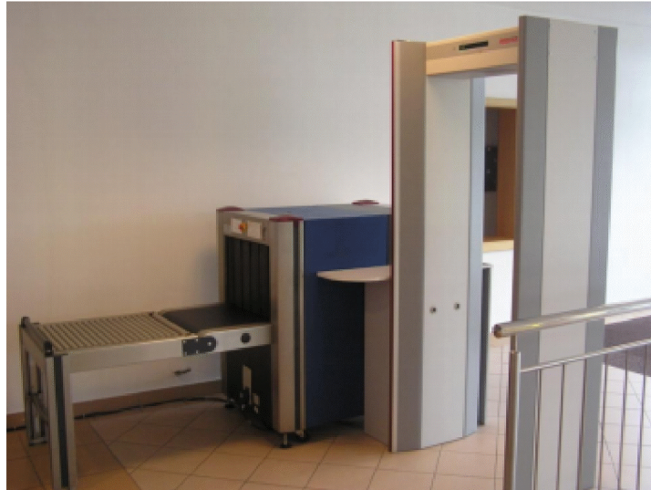
Obrázok 4: Rámový detektor kovu s pásovým RTG detektorom (Tureček, 1998)
