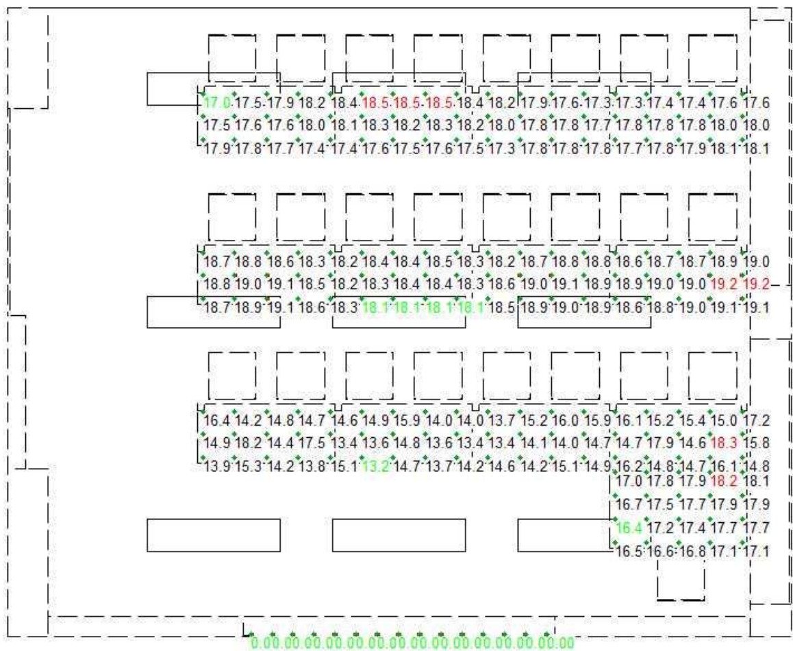
Obr. 40. Oslnenie UGR v kontrolných bodoch učebne, reálna sústava
