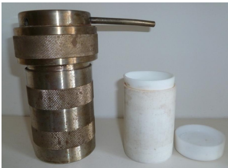
Obrázek 13 – Kovový autokláv s PTFE nádobou pro přípravu Fe nanočástic.
