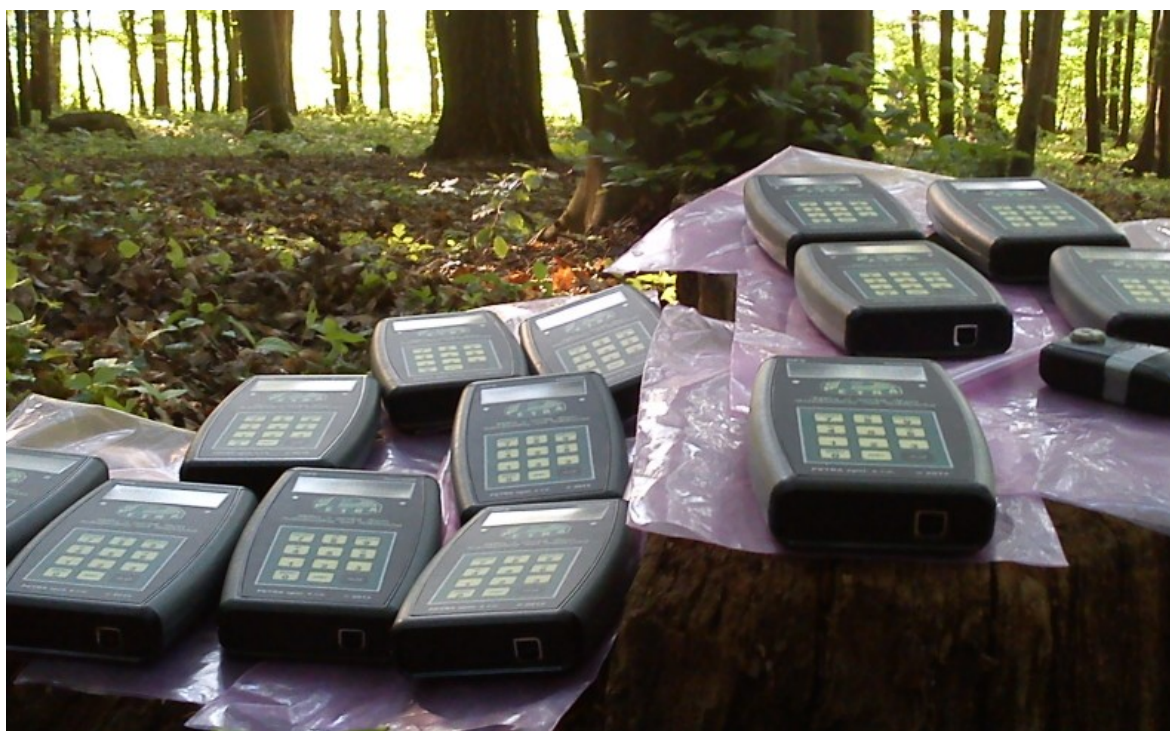
Obrázek 20 Test příjmu signálu GPS stíněného korunami stromů
