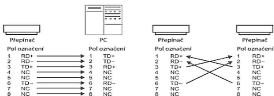
Obr. 2-20 Straight-through (nalevo) a Cross-over kabely (napravo)
