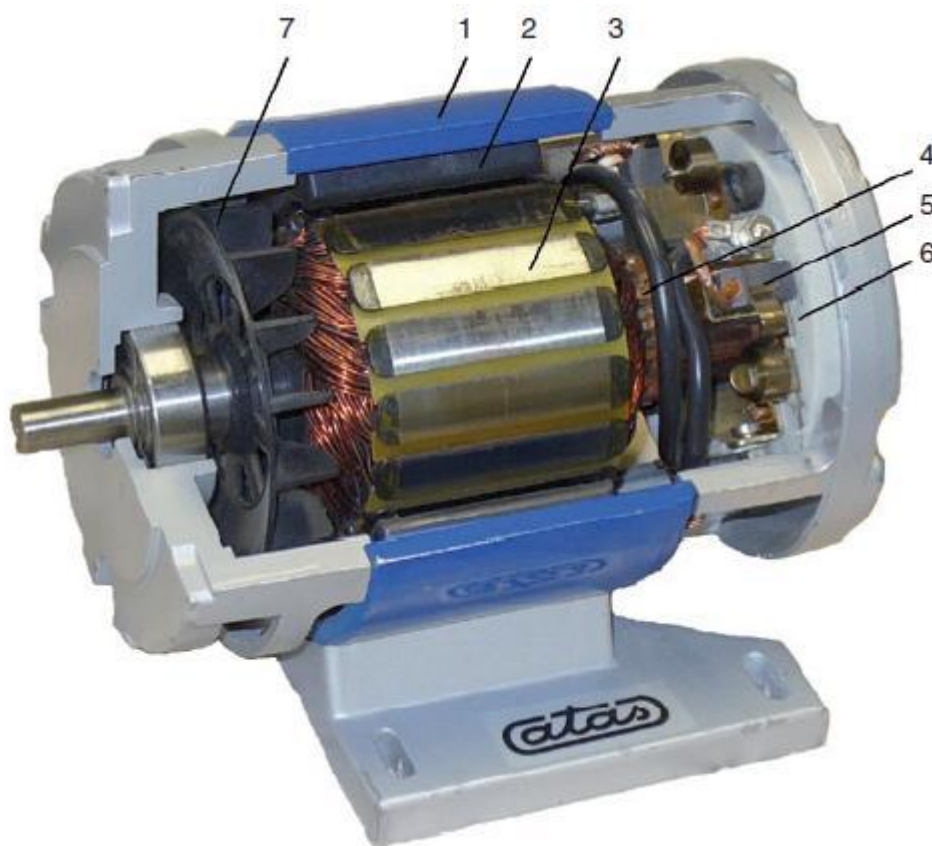
Obr. 9. 1-kostra statoru, 2-magnety, 3-rotorový svazek, 4-komutátor, 5-kartáč(uhlík), 6-držák kartáčků, 7-chladicí ventilátor elektromotoru
