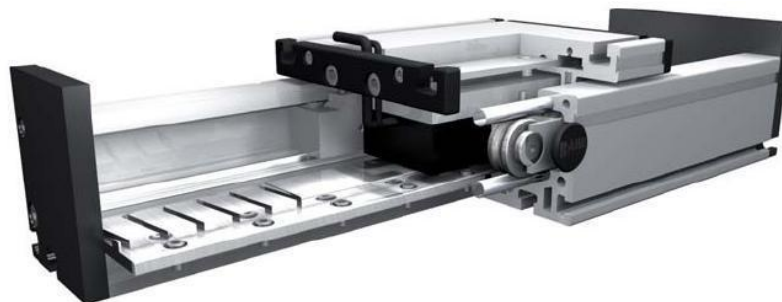
Obr. 33. Lineární motor zakomponovaný do lineárního systému (rotor tvoří jednotlivé magnety a stator je pohyblivá část)
