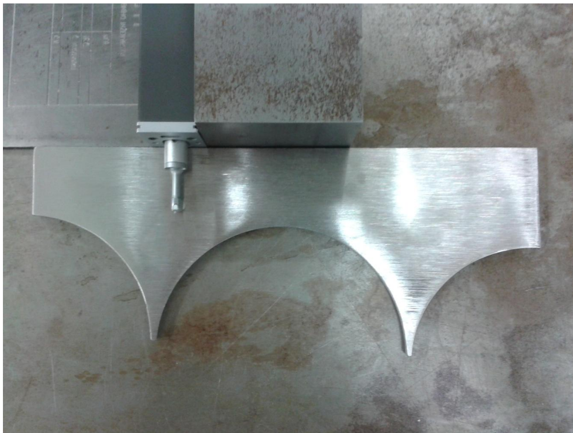
Obr. 29 Detailní záběr při měření drsnosti daného vzorku
