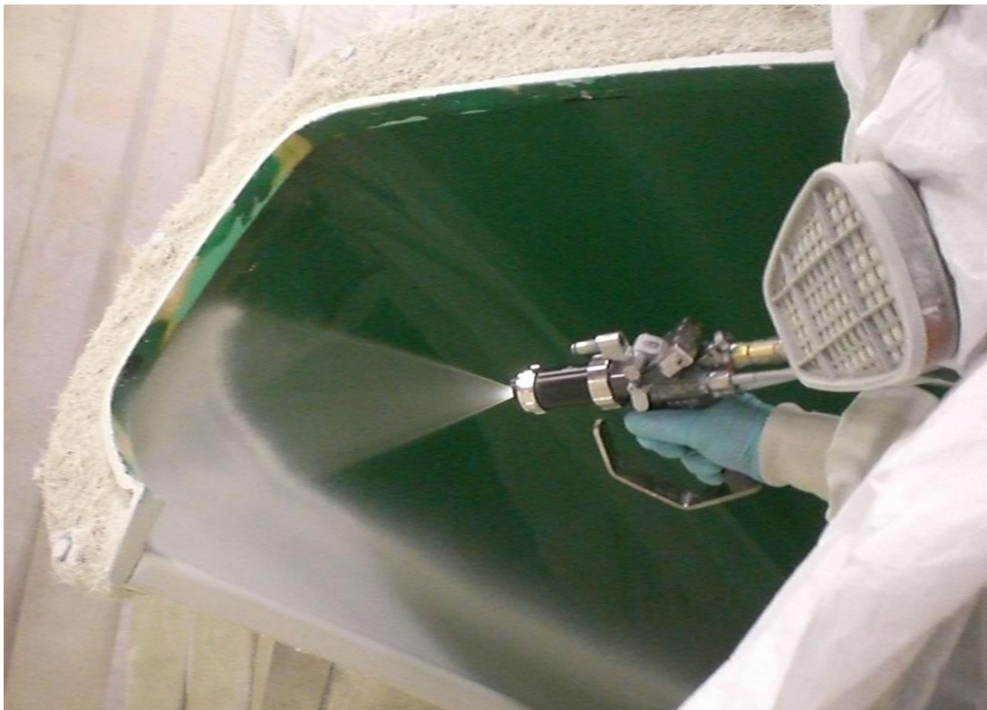
Obr. 6. Nanášení gelcoatu stříkáním [12]
