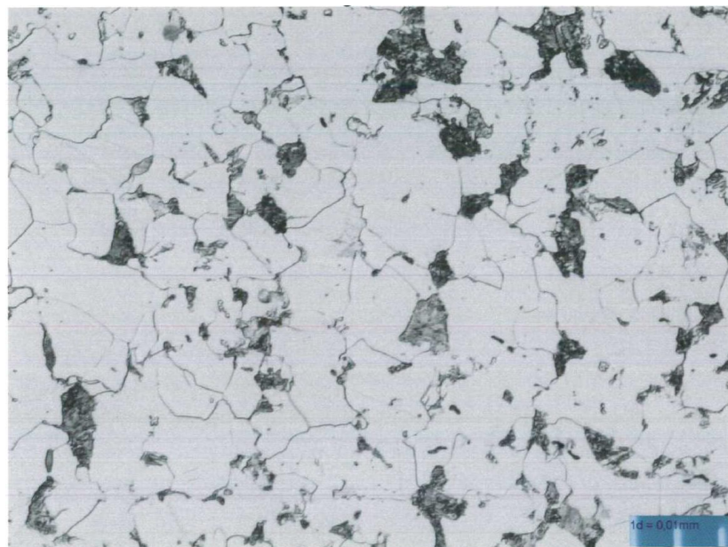
Obr. 24. Mikrostruktura pro vnější část ohybu, 500x
