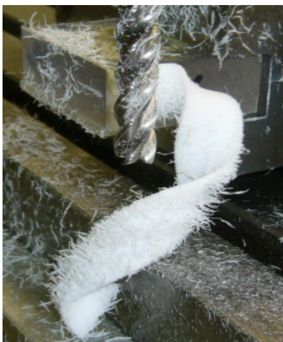
Obr. 40 Obrobený vzorek PC s použitím CO 2
