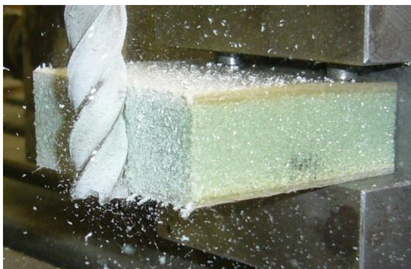
Obr. 70 Obrábění třívrstvého laminátu
