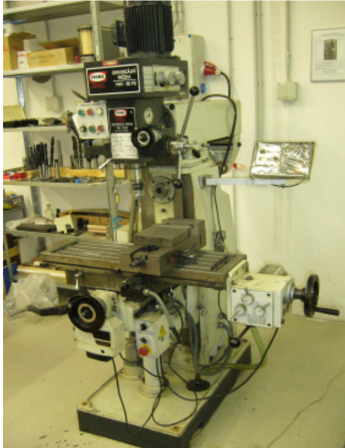
Obr. 33 Univerzální frézka FHV-50PD
