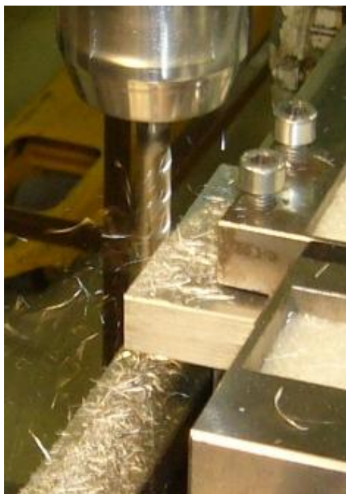
Obr. 64 Obráběný vzorek duralu
