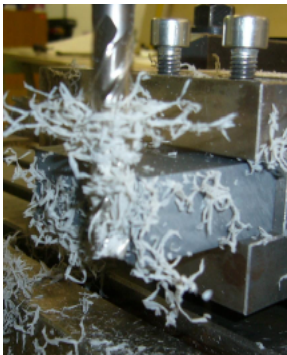
Obr. 52 Obrábění vzorku z PVC
