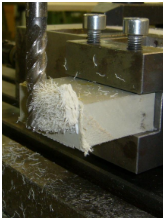
Obr. 58 Obrábění ochlazeného vzorku z PP
