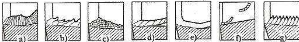
Obr. 8. Základní druhy tvářených třísek při obrábění kovů [1]
