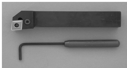
Obr. 6. Nůž s vyměnitelnou břitovou destičkou
