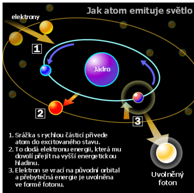
Obr. 16. Schéma uvolnění fotonu z plynového iontu [6]
