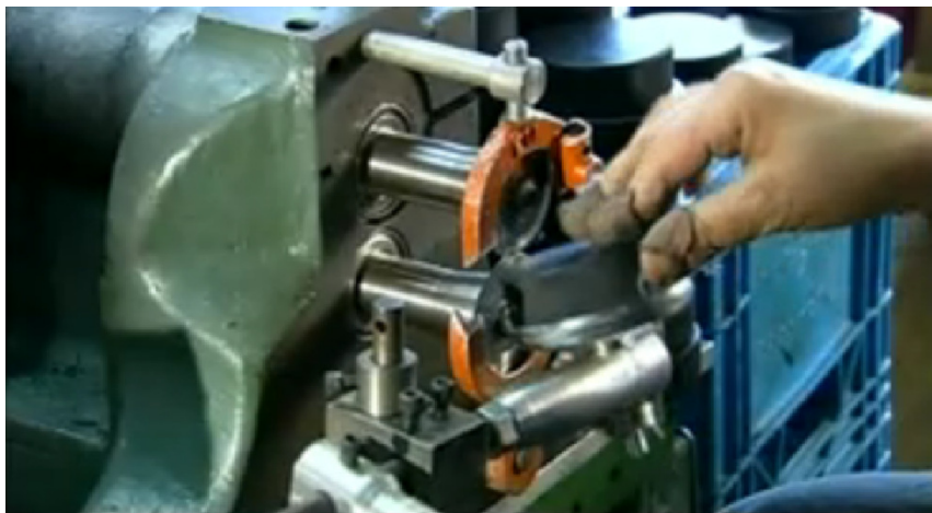
Obr. 7 Odstranění přetoků pomocí řezačky (zdroj: [5])
