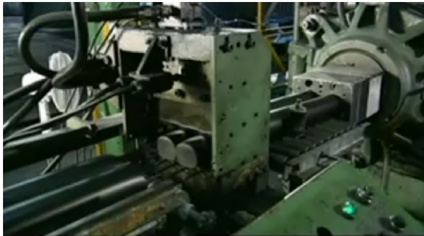
Obr. 4 Výroba polotovaru na vytlačovacím lisu (zdroj: [5])
