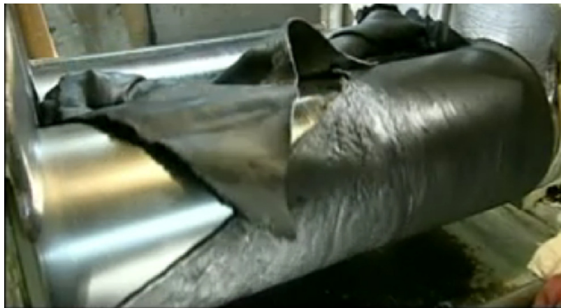
Obr. 3 Míchání směsi na dvouválci (zdroj: [5])
