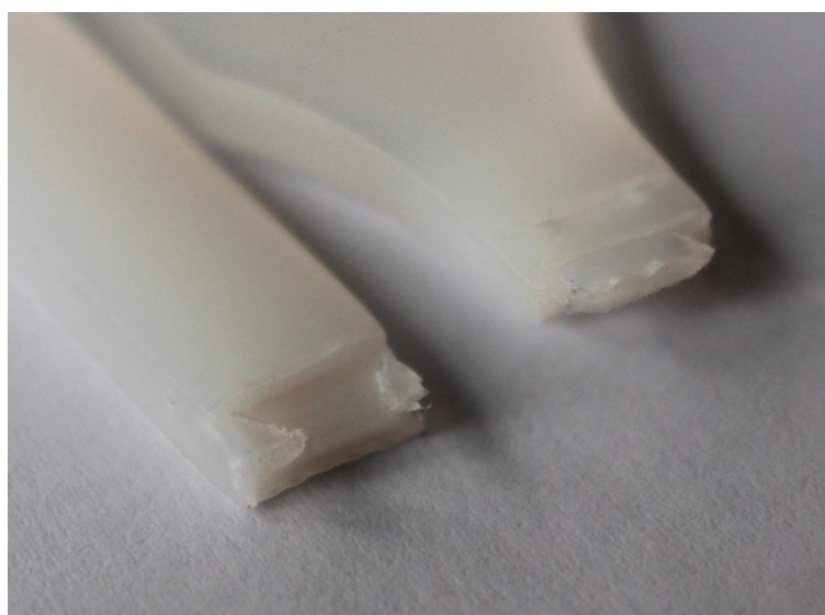
Obr. 19. Přetržení zkušební vzorku série č. 2
