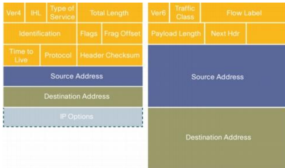
Obr. 1. Porovnání hlaviček IPv4 a IPv6
