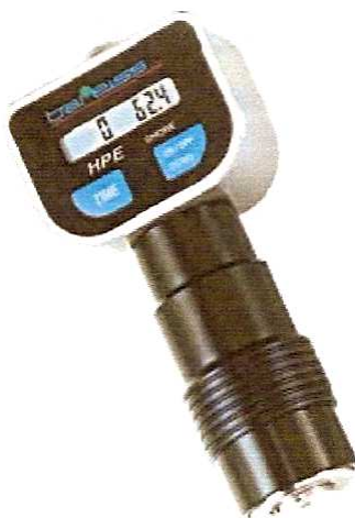
Obr. 24. Tvrdoměr Shore typu HPE s měřicí hlavou Shore D
