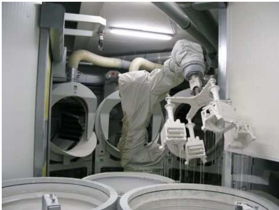
Obr. 5 Obalování voskových modelů (Interní materiály firmy, 2011)
