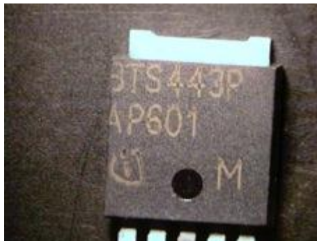
Obr. 6 Zobrazení nedokonalostí označení součástky. [3]
