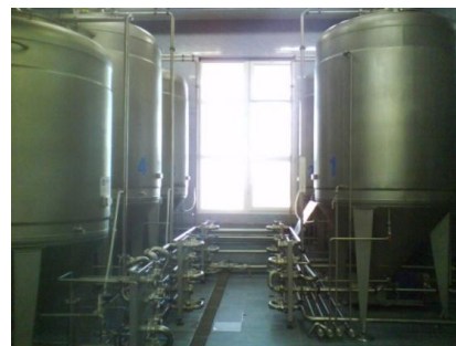
Abb. 13: Die Hefen werden sorgfältig in gekühlten Edelstahltanks gepflegt, die durch Nummern identifiziert werden. Die Nummern geben an, wie oft die Hefen verwendet werden.
