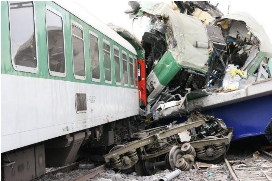
Obr.1 Destrukce TDV po srážce se zřícenou konstrukcí mostu
