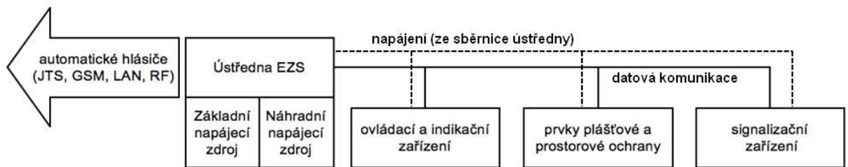
Obr. 2. Zjednodušená struktura drátového propojení EZS [8]
