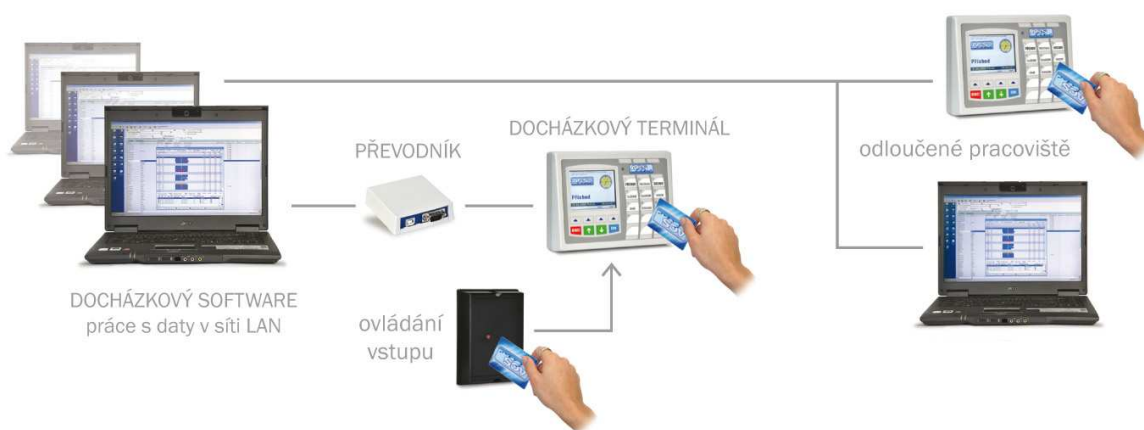
Obr. 21 Princip funkce docházkového software
