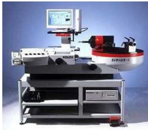
Obr. 11. Horizontálny predzriaďovací prístroj (Teximp, 2007)
