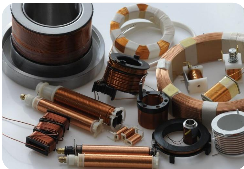
Obrázek 17 – Výrobky navíjení a zalévání ( Hanhart Morkovice: Od vývoje k produkci )
