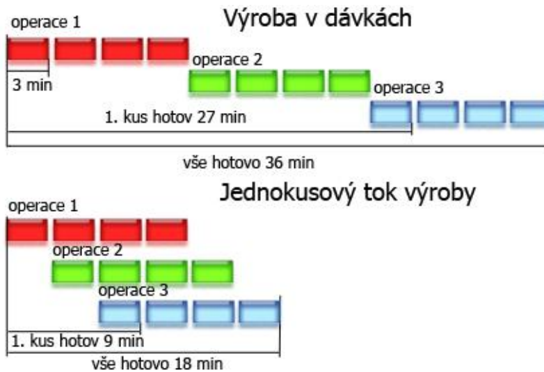
Obrázek 6 - OPF vs. dávková výroba (Volko, 2009b)
