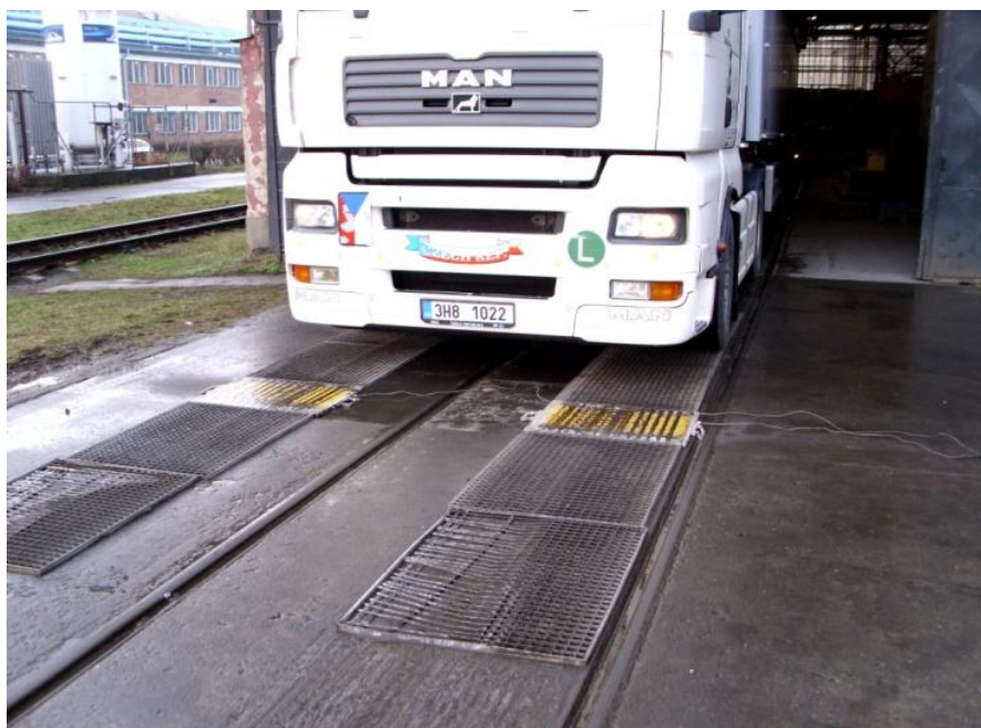
Obr. 20 Vjezd naloženého vozidla přes váhu do haly (vlastní zpracování)
