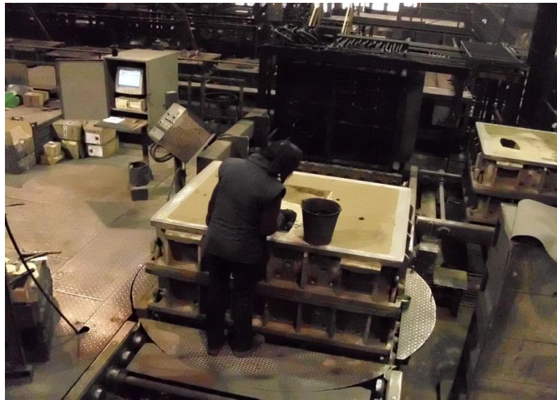
Obr. 14 Nátěr forem lihografiovým nátěrem (vlastní zpracování)
