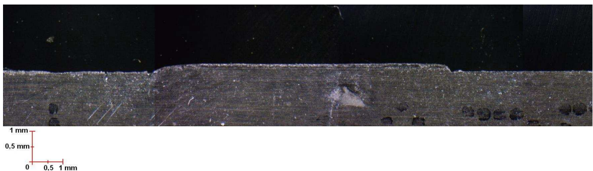
Obr. 81. Profil opotřebovaného brousicího kotouče vybroušený na planžetě – obrázek získaný z mikroskopu Carl Zeiss
