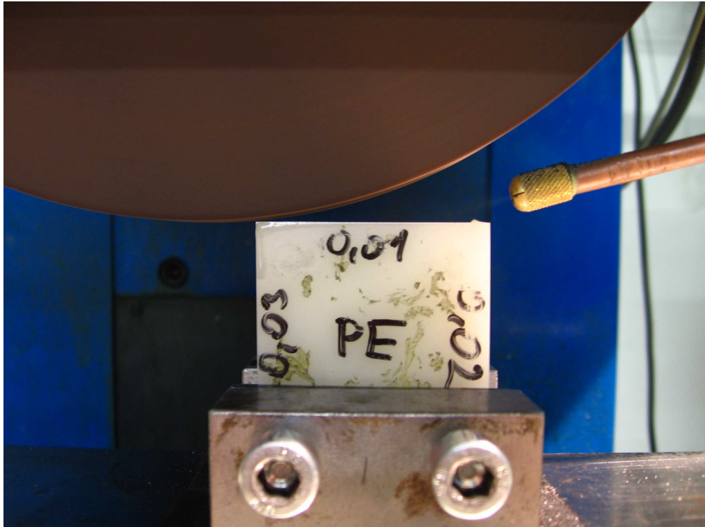
Obr. 18. Detail na trysku aplikátoru MQL během experimentu
