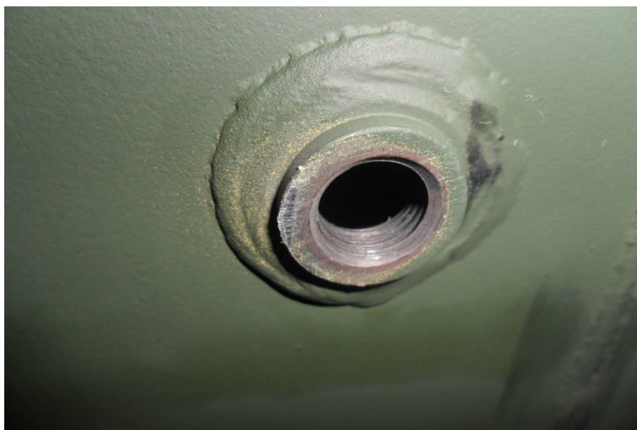
Obr. 19. Vypouštěcí otvor nádrže Tatra.
