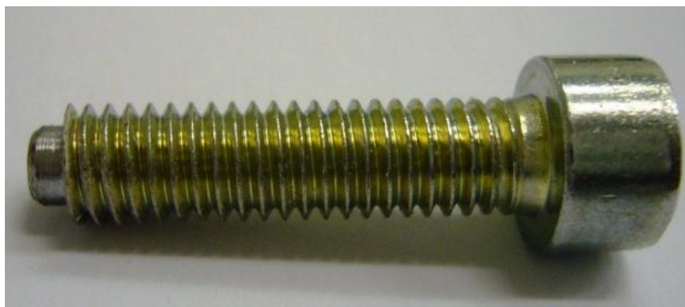
Obr. 45 Detail seřizovacího šroubu
