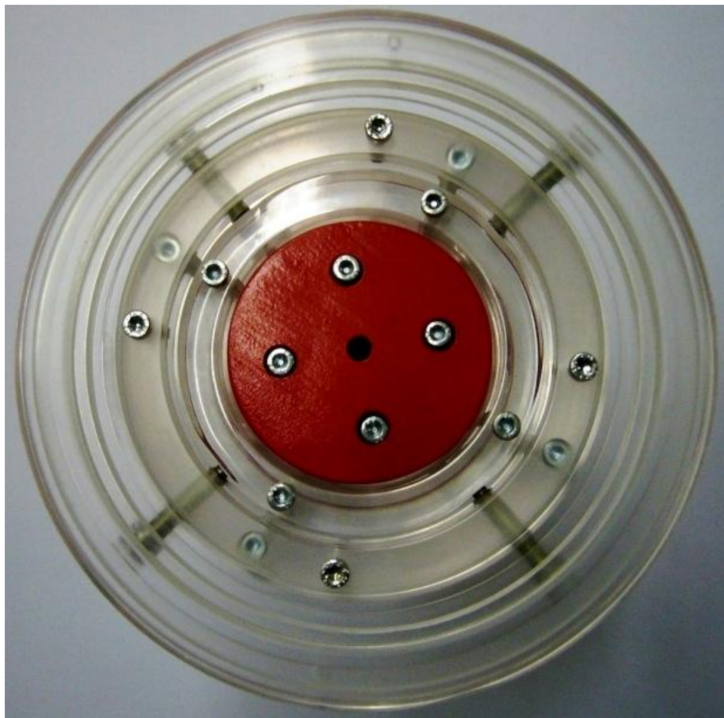
Obr. 49 Detail modelu vytlačovací hlavy na tubulární fólii
