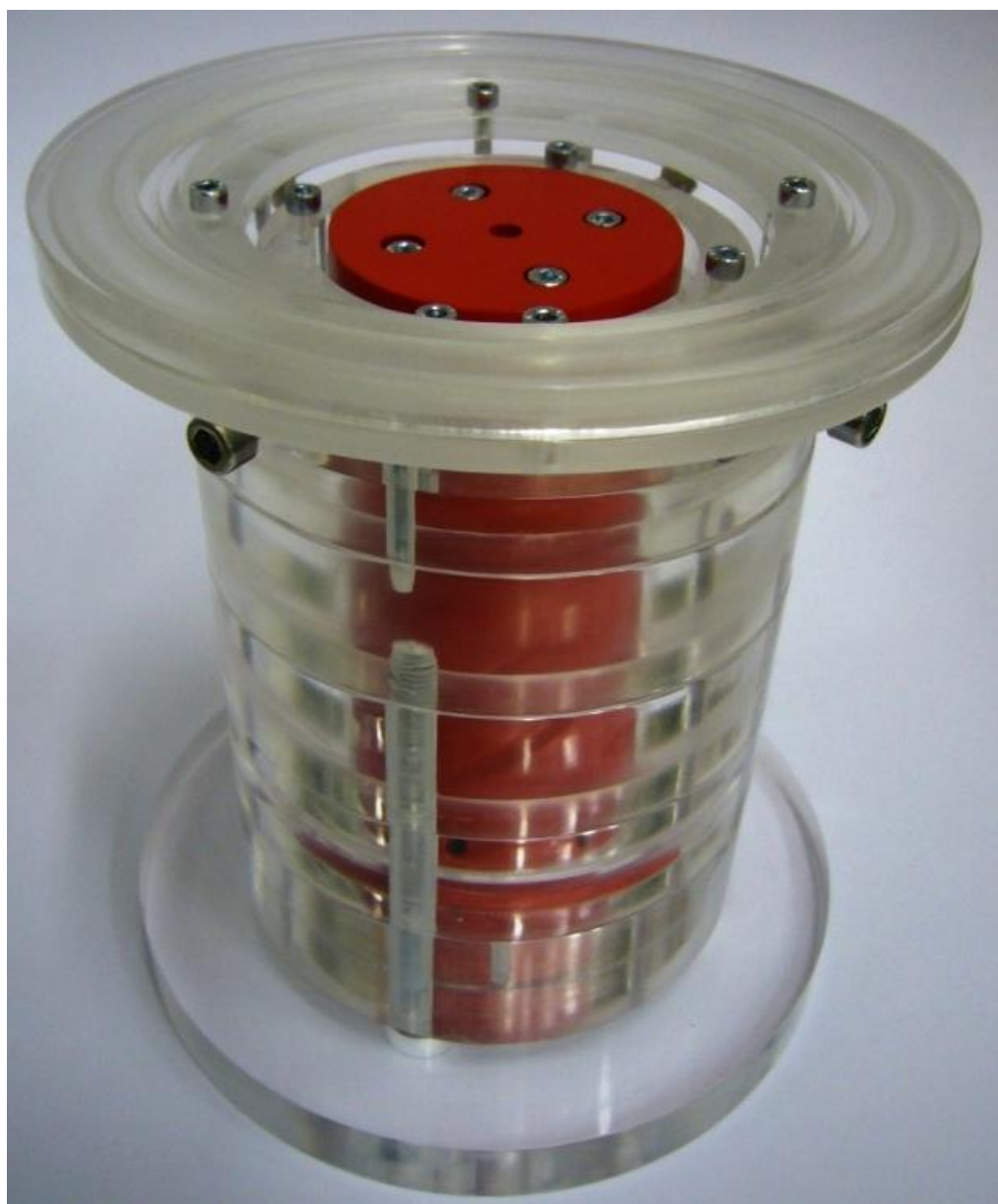
Obr. 48 Model vytlačovací hlavy na tubulární fólii
