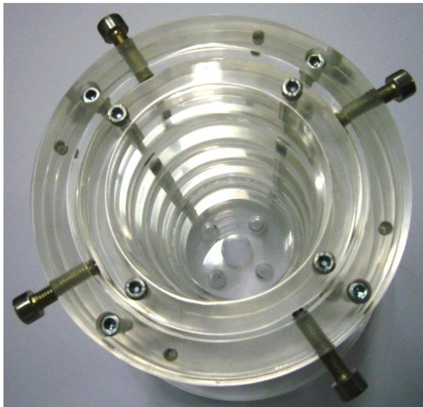
Obr. 44 Upevnění hubice se seřizovacími šrouby
