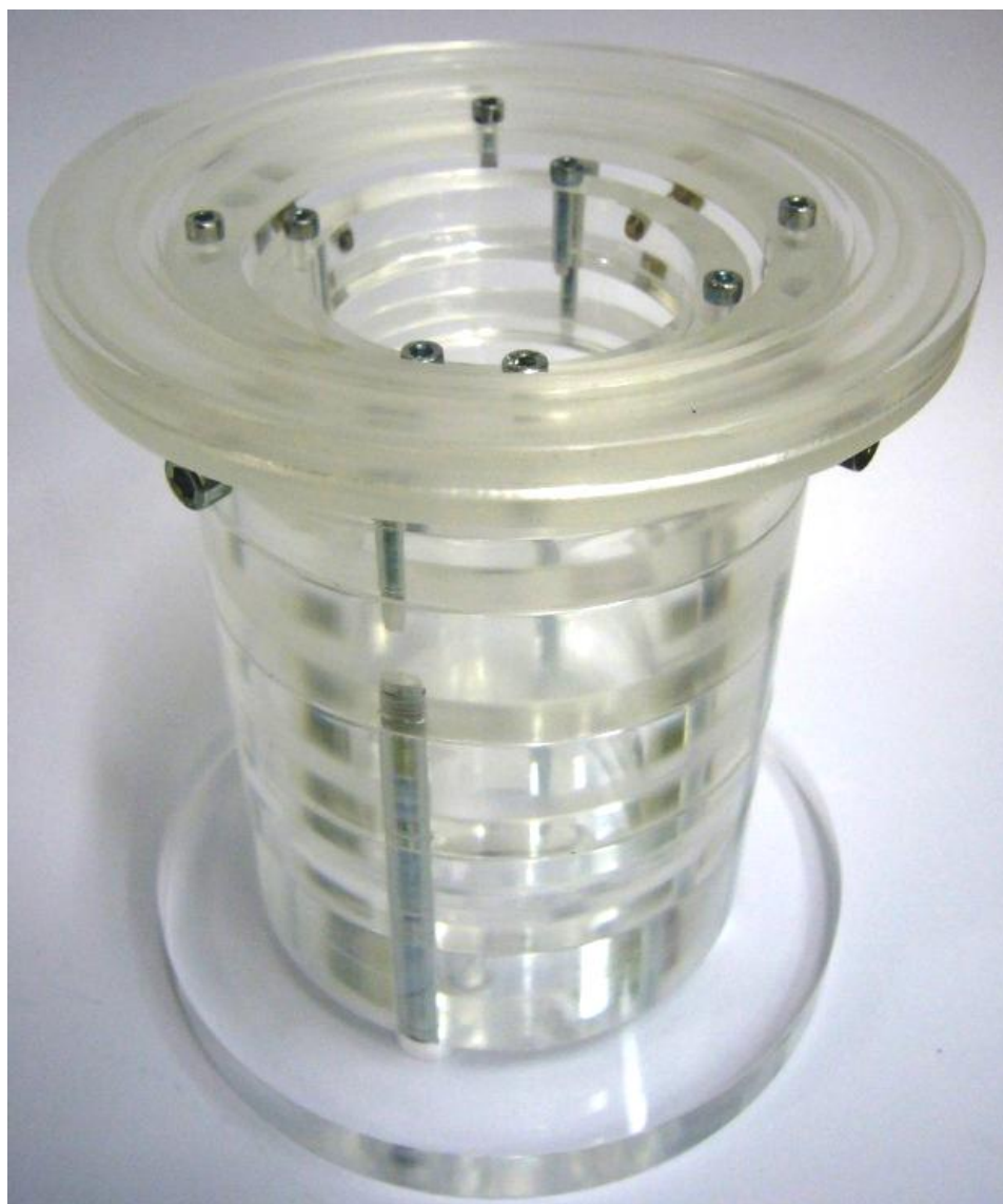
Obr. 47 Uchycení chladícího prstence
