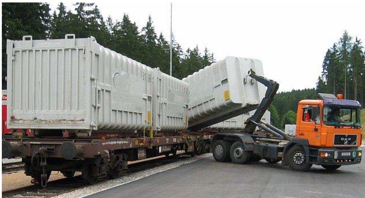
Obrázek 6-Příklad manipulace s ACTS kontejnery
