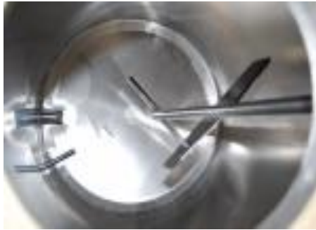
Obr. 13. Vnitřek tanku, je vidět míchadlo, výpustný ventil a teploměr
