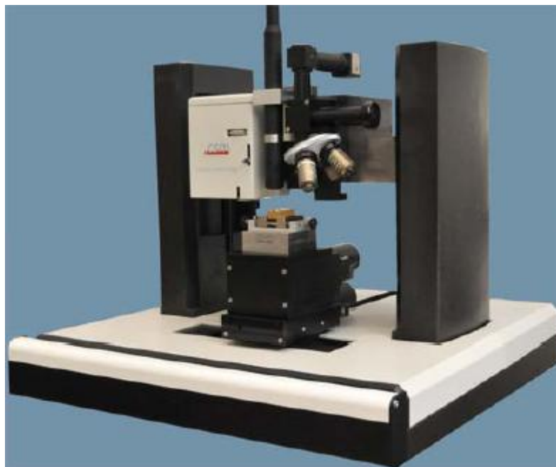
Obr. 23 Mikrotvrdomer CSM Instruments – pohľad 1
