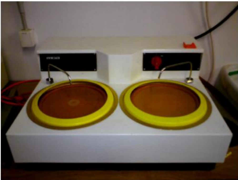
Obr. 21 Přístroj MTH na leštenie kovovýchkušobných vzoriek
