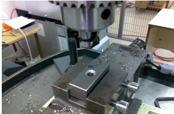
Obr. 77. Zahlubování záhlubníkem ČSN 22 1625 do materiálu 12 050.1
