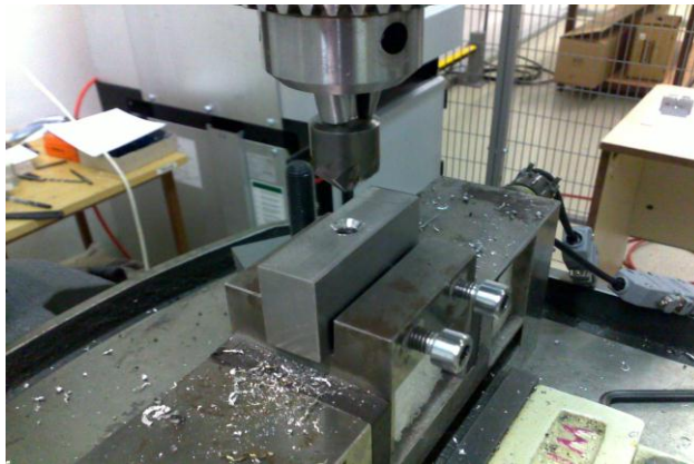
Obr. 81. Zahlubování záhlubníkem ČSN 22 1627 do materiálu 14 220.4
