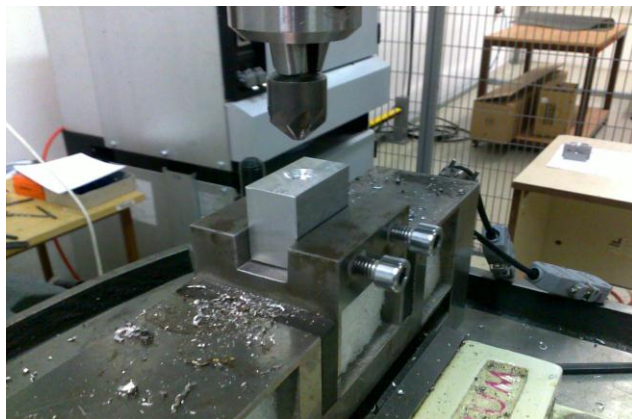
Obr. 82. Zahlubování záhlubníkem ČSN 22 1627 do materiálu 42 4201
