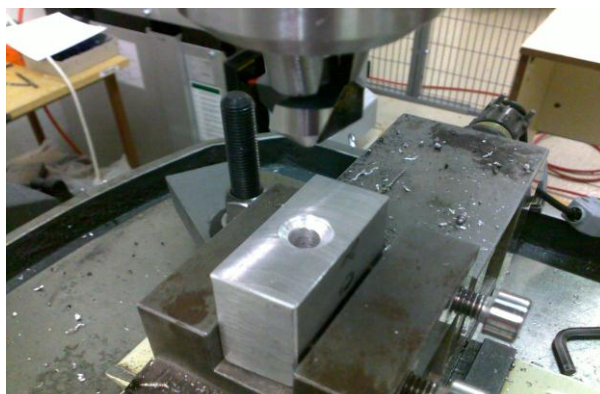
Obr. 79. Zahlubování záhlubníkem ČSN 22 1625 do materiálu 42 4201
