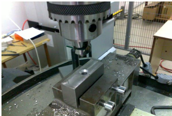
Obr. 78. Zahlubování záhlubníkem ČSN 22 1625 do materiálu 14 220.4
