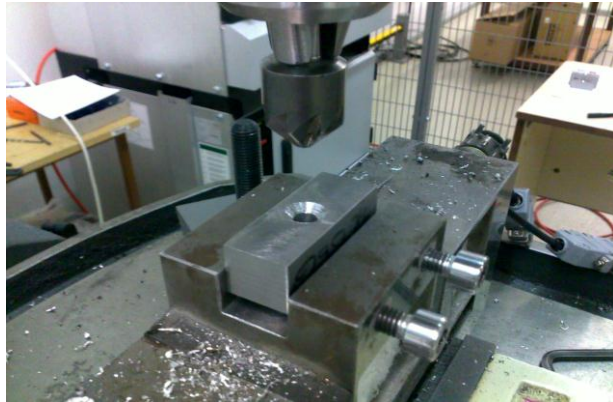
Obr. 80. Zahlubování záhlubníkem ČSN 22 1627 do materiálu 12 050.1
