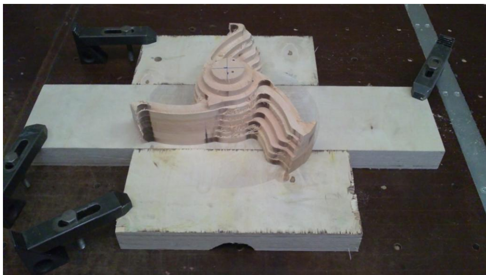
Obr. 85. Operace hrubování tvaru Vrtule1
