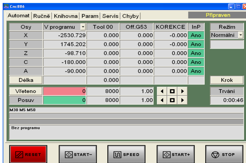
Obr. 74. Automatické řízení stroje
