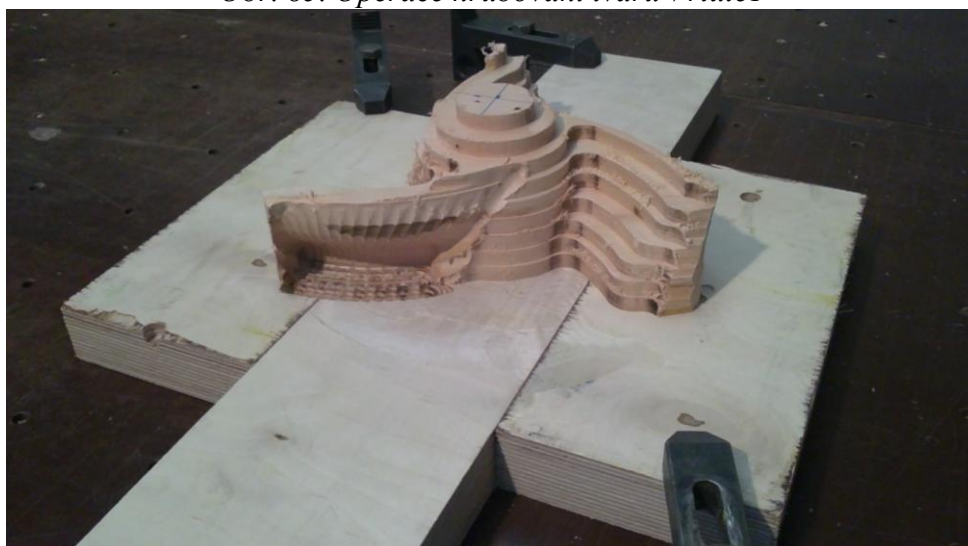
Obr. 85. Operace hrubování tvaru Vrtule1
