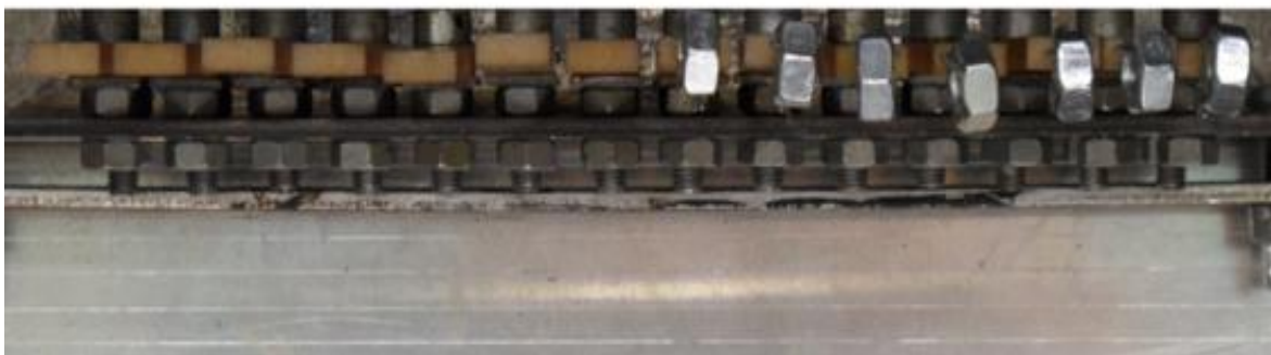
Obr. 36 Zobrazení zkušebních tělísek PA9T v různých dávkách ozáření v čase 60min. o teplotě 250°C
