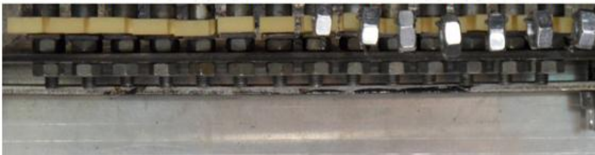
Obr. 35 Zobrazení zkušebních tělísek PA9T v různých dávkách ozáření v čase 30min. při teplotě 220°C
