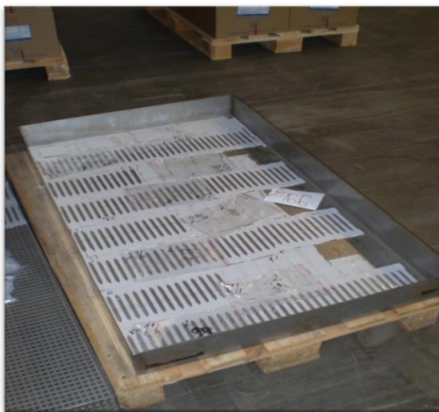
Obr. 26 Uložení zkušebních tělísek [14]
