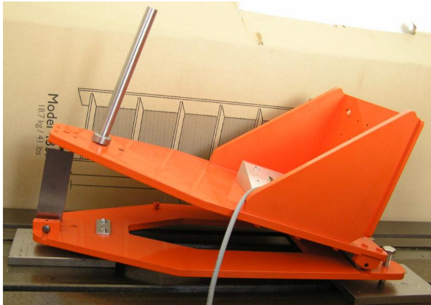
Obr. 24 Podkládání kalibru sklonu Johanssonovými měrkami
