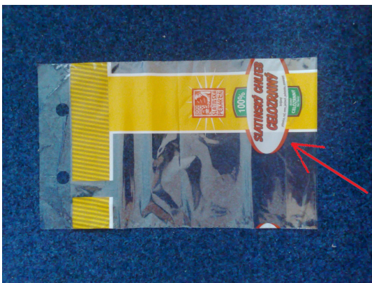
Obr. 19 Špatné umístění tisku
