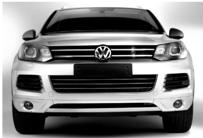
Obrázek 10: Příklad aplikace TPO – nárazník vozu VW Touareg [20]
