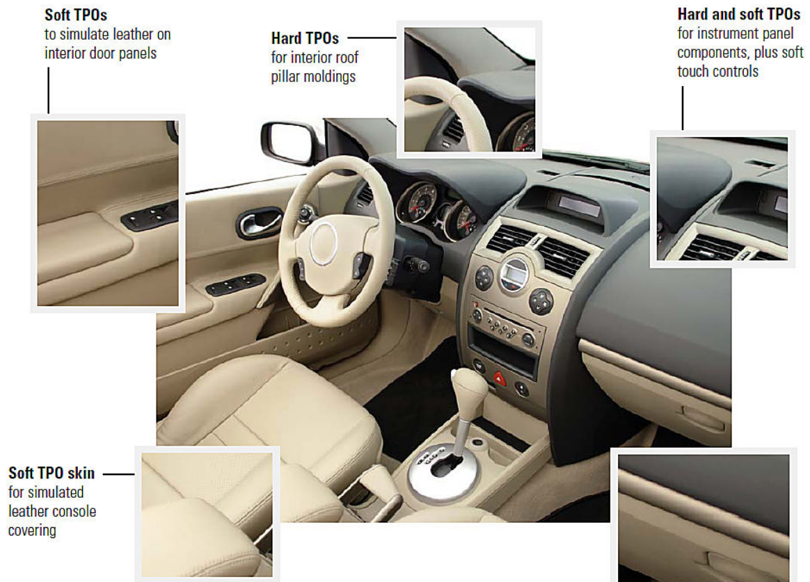
Obrázek 11: Příklady aplikací TPO v interiéru [18]
