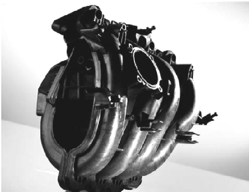
Obrázek 16: Příklad aplikace PP+GF – sací potrubí VW [20]
