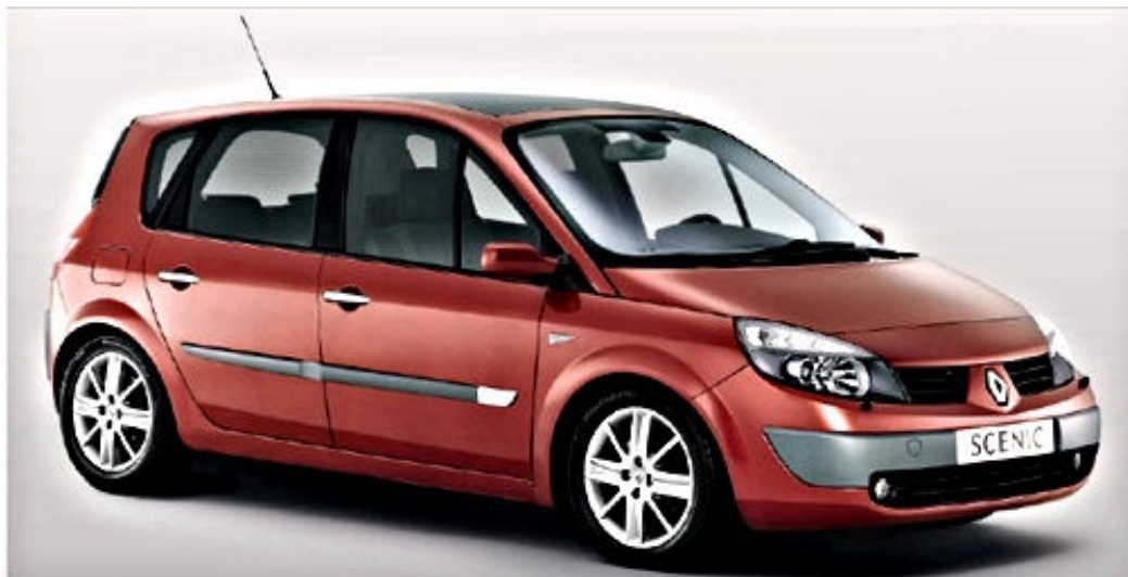
Obrázek 18: Příklad aplikace PP plněného talkem - nárazníky a boční lišty Renault Scenic [11]
