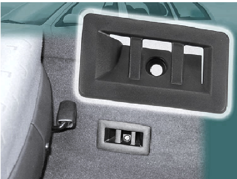
Obrázek 21: PP+PS zn. Elan XP 515 – větrací systém vozů VW, Audi [36]
