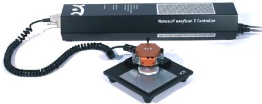
Obr. 17: AFM pracující ve statickém módu, Nanosurf easyScan2 [37]
