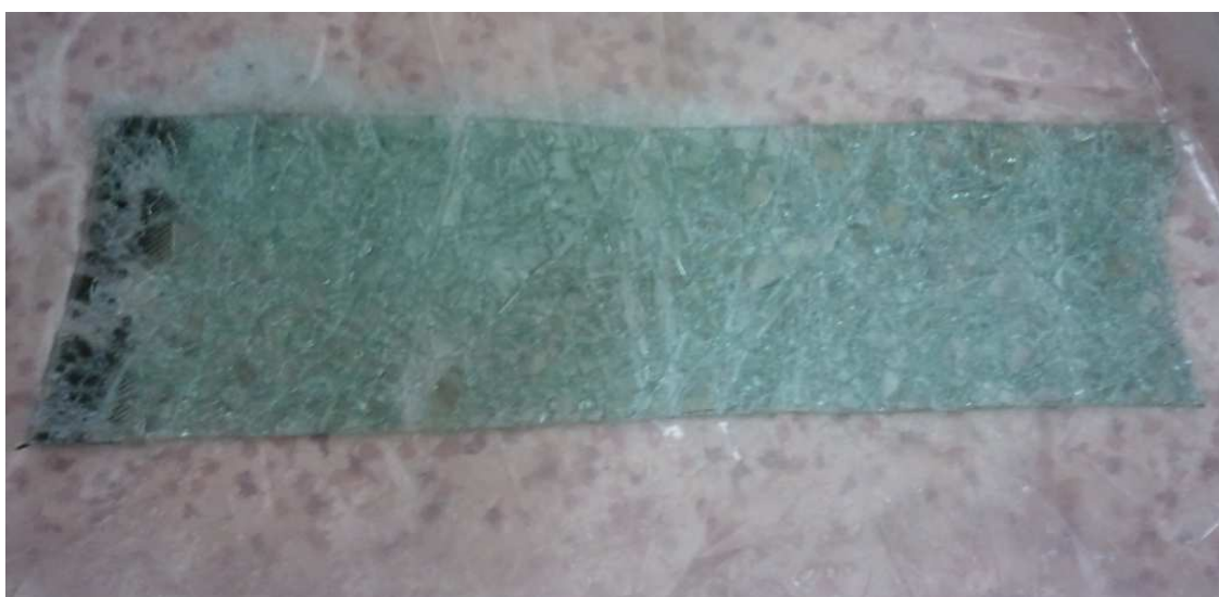
Obr. 15: VBS sklo před vložením do vodného roztoku NaOH
