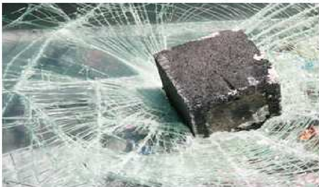
Obr. 7: VBS při nárazu těžkým předmětem (cihly)[18]
