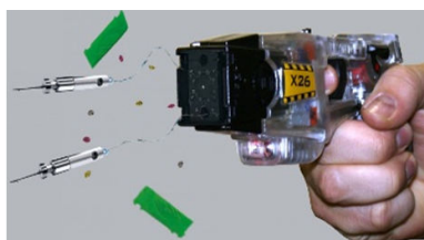
Obr. 23. Demonstrace výstřelu elektrod.
