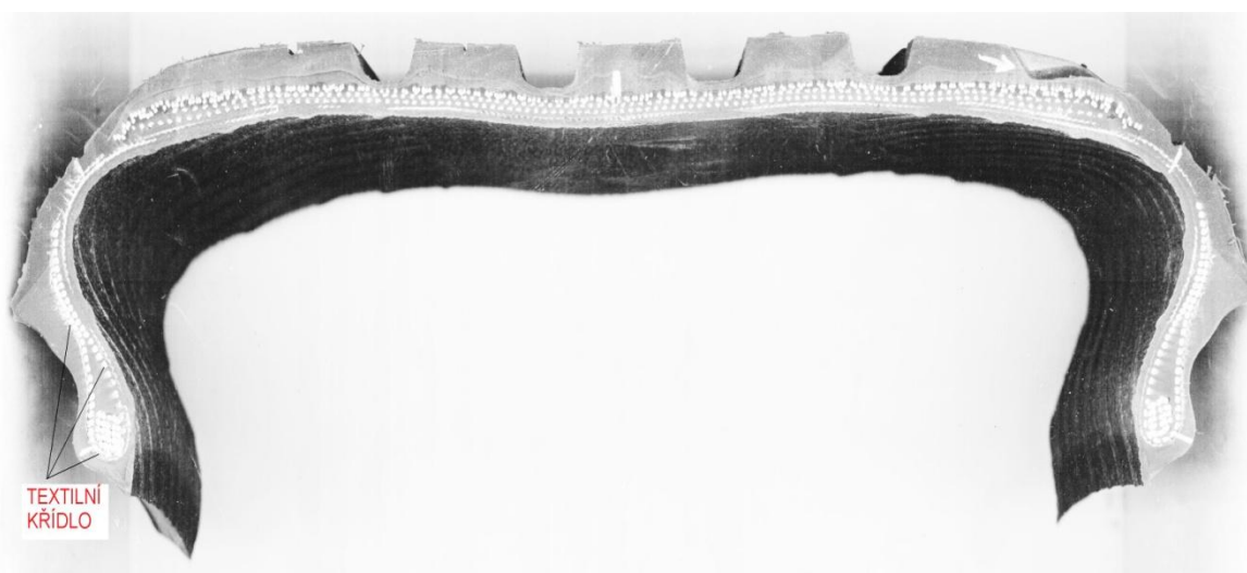
Obr. 10 Příčný řez pneumatiky s textilním křídlem
