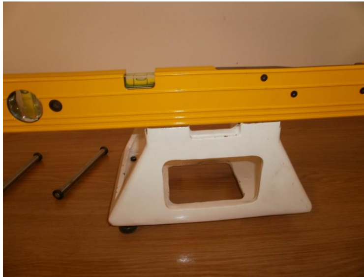
Obr.10 Dôkaz o vodorovnej polohe statickej vyvažovačky
