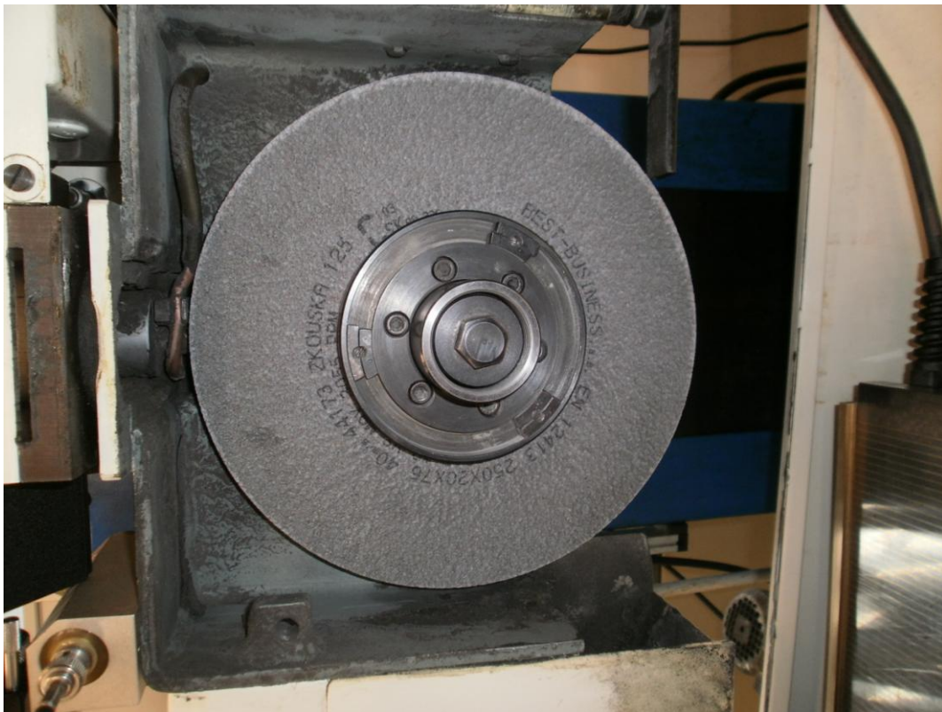
Obr.16 Kotúč pripevnený v brúske po druhom vyvážení
