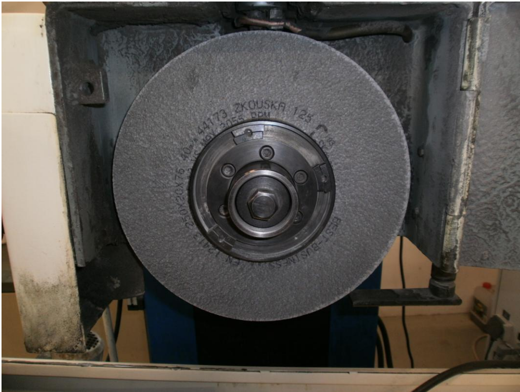
Obr.11 Kotúč pripevnený v brúske po prvom vyvážení
