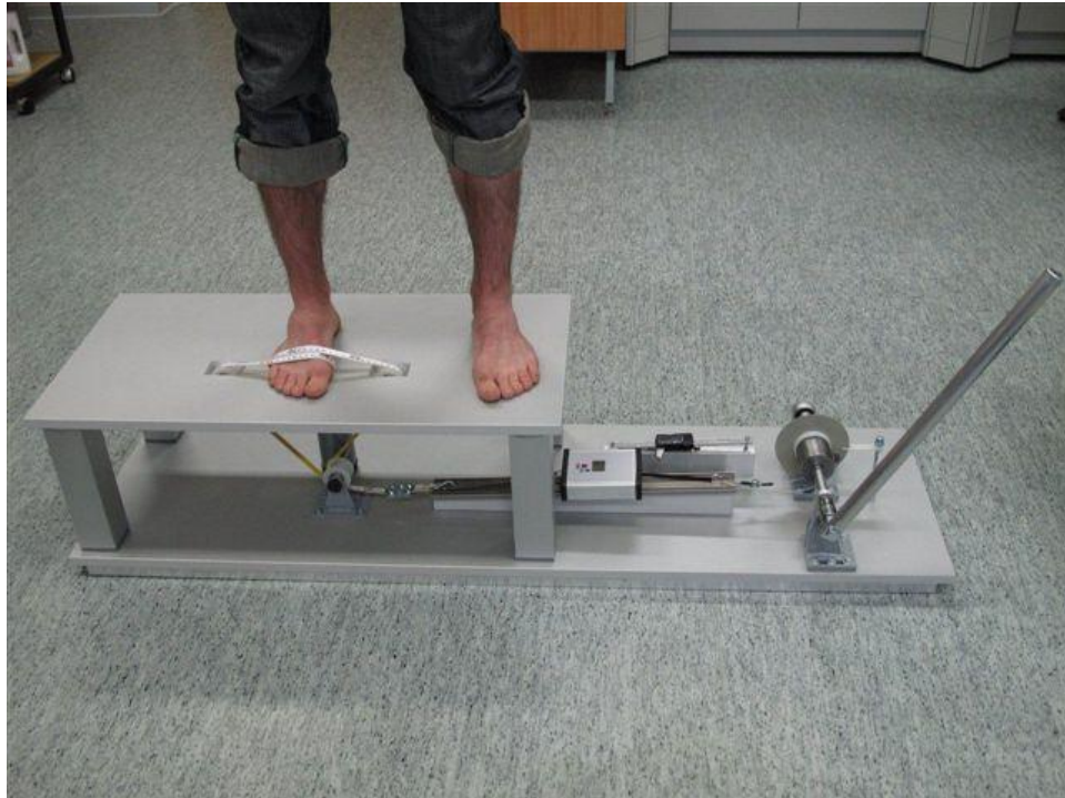
Obr. 30 Zařízení pro měření deformační odezvy chodidla
