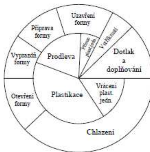
Obr. 22 Vstřikovací cyklus termoplastů
