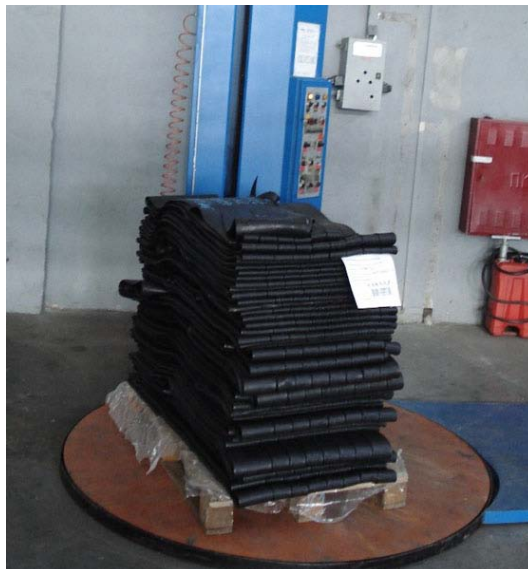
Obr. 1. Spôsob ukladania (vig-vag) kaučukovej zmesi [10].
