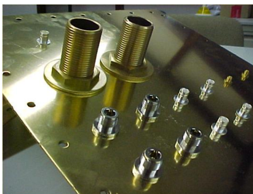
Obrázek 32 Panel s anténními filtry a filtry pro optické vedení
