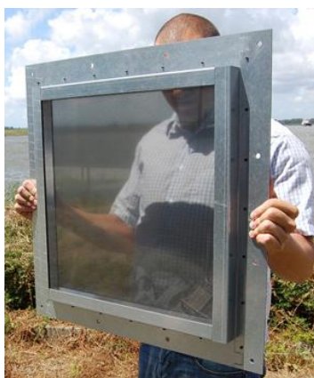
Obrázek 22 Stíněné okno pro modulární systém komor
