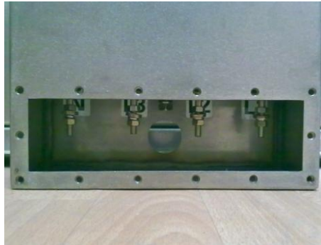
Obrázek 40 Pohled na napájecí filtr
