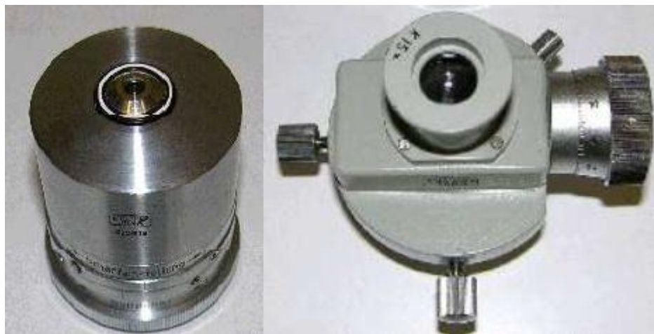
Obr. 11 Nástavec a merací okulár mikrotvrdomeru Hanneman
