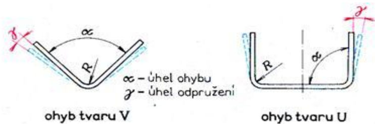
Obr.27 Odpružení materiálu pro ohyb tvaru V a U
